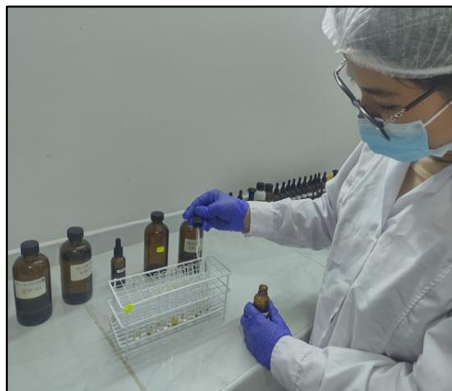
Figura 16. Añadiendo el extracto seco al tubo de ensayo para prueba de solubilidad
