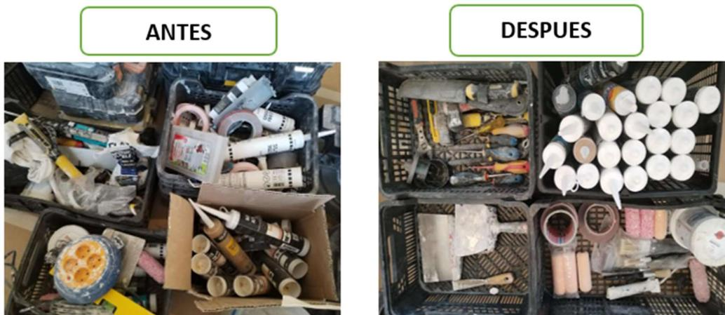
Según la figura 10 y Figura 11 detallamos el proceso para identificar la importancia de utilidad de cada elemento dentro de nuestra área e trabajo durante la aplicación de la 1S Seiri.
