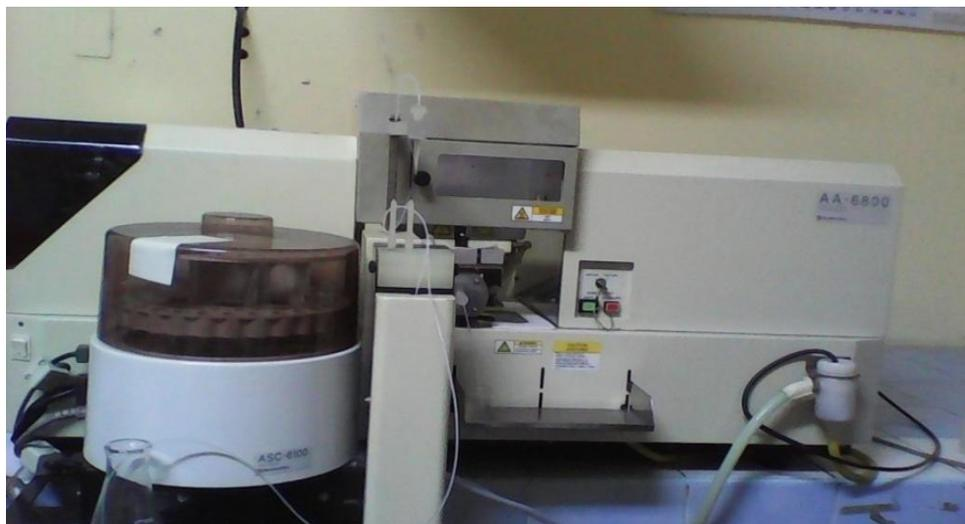
FiguraN<sup>o</sup>12 Equipo de Absorción Atómica SHIMADZU con horno grafito (USAQ).
