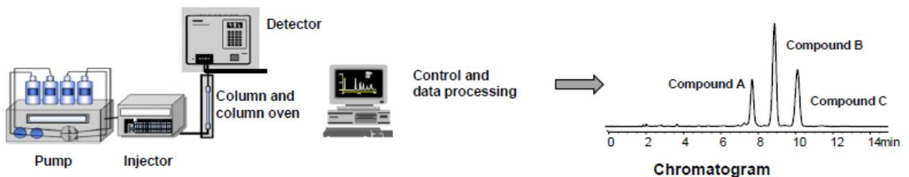
**Figura 5. Componentes de un HPLC**
