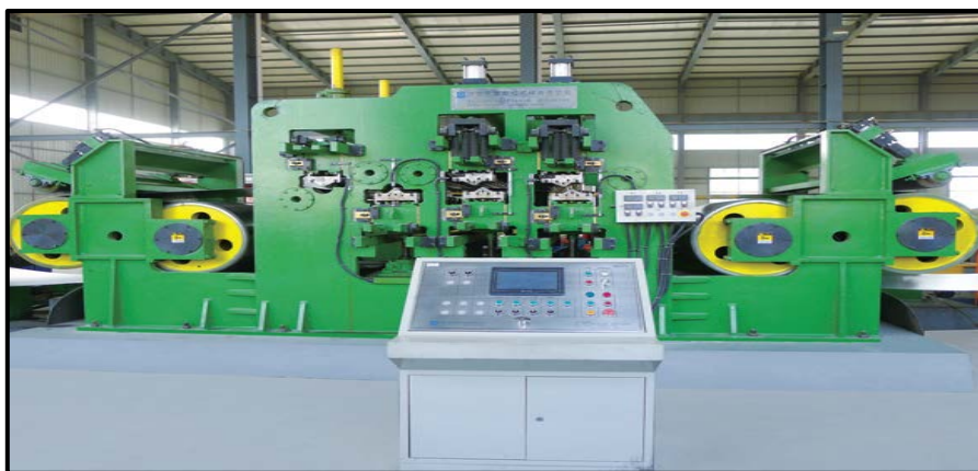
Figura 14. Vista lateral de la nueva tecnología de aplanado y corte.
