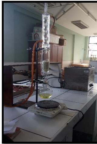
Figura 7: Proceso de desengrasado
