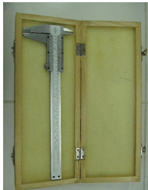
Calibrador Vernier o Pie de Rey. Utilizado para cuantificar los halos de inhibición.
