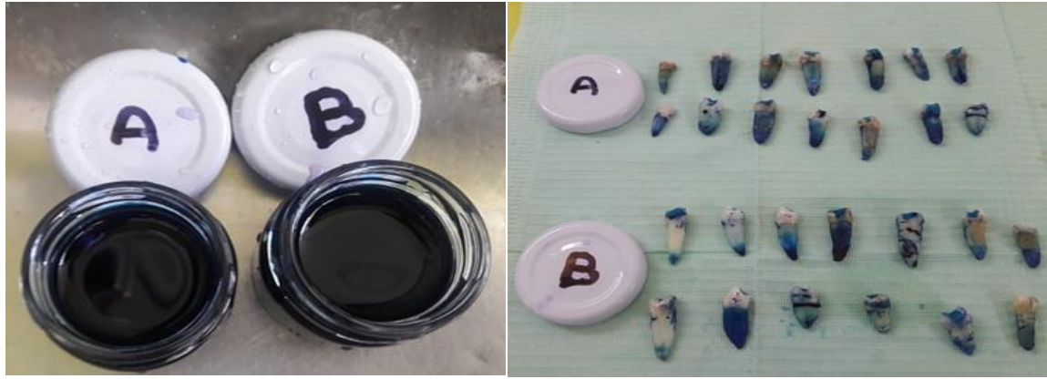
IMAGEN 26, 27 muestras sumergidas en azul de metileno al 10%
