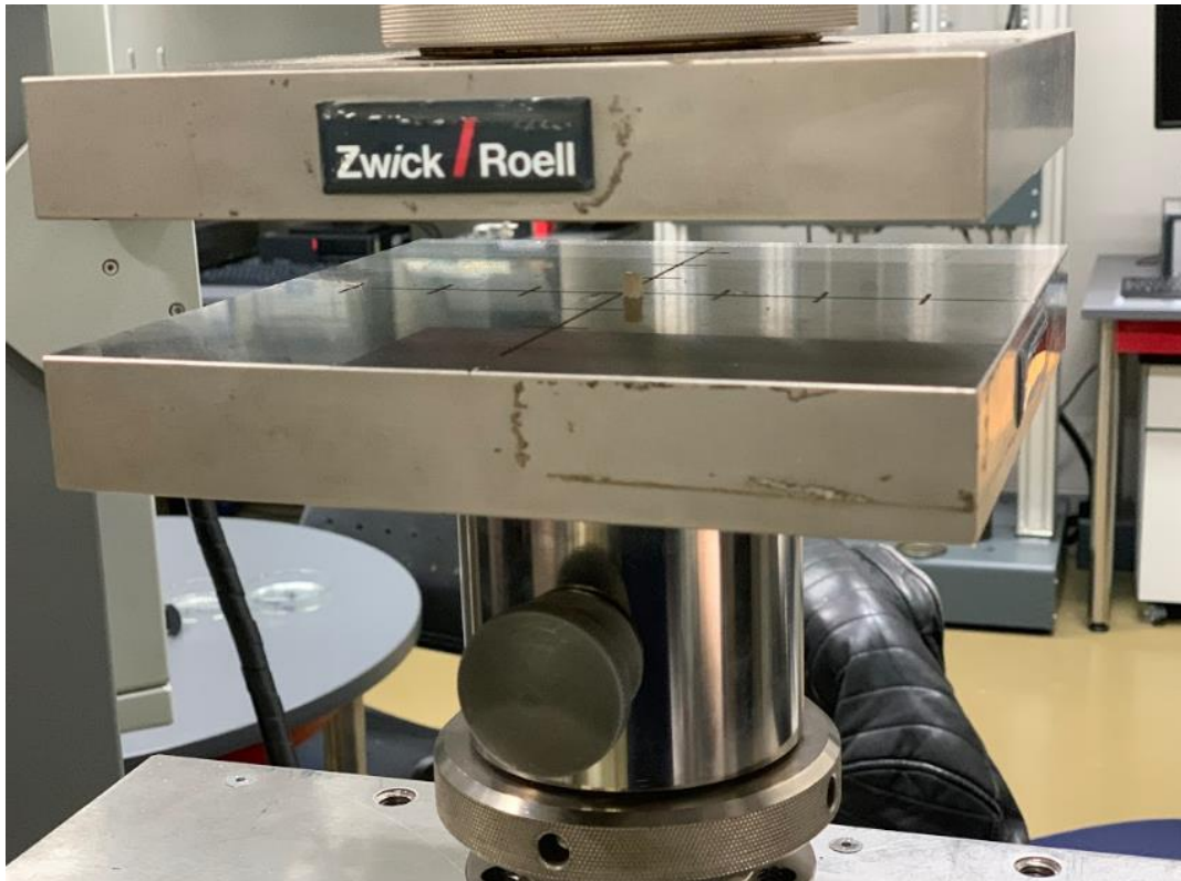
ESPECIMEN SOMETIDO A LA FUERZA DE COMPRESION DE LA MAQUINA DE ENSAYOS UNIVERSAL
