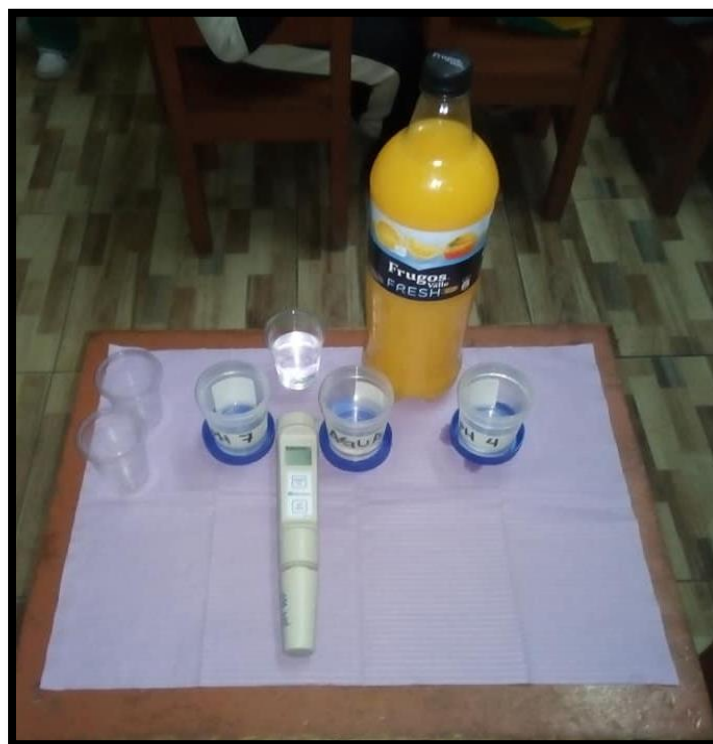
FOTOGRAFIA N a 03: POTENCIOMETRO BIOCARE Y TOMA DEL pH DE LA BEBIDA.
