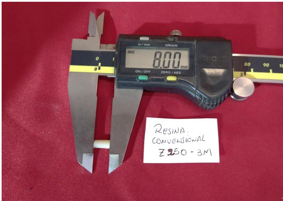
**Longitud de los cilindros de resina (8 milímetros)**
