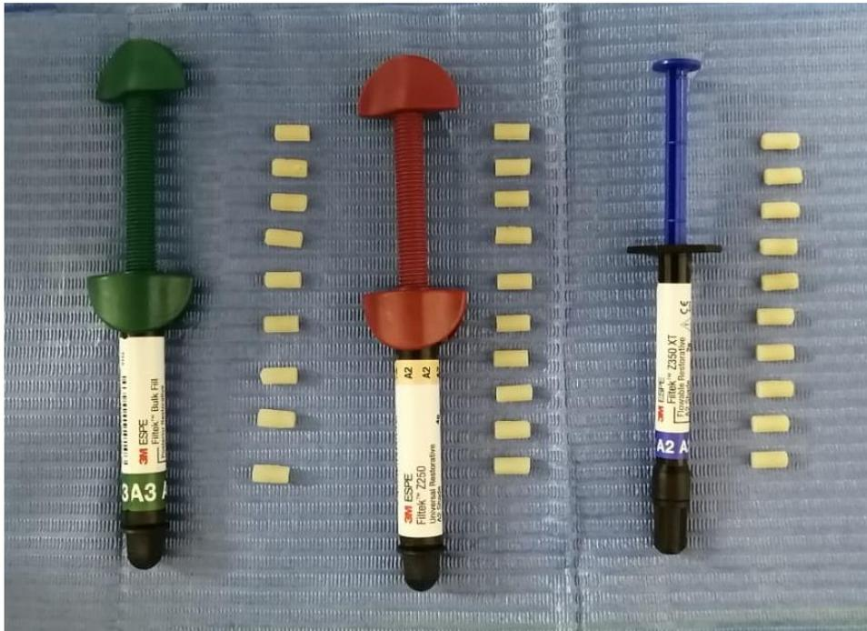
**Cilindros de resina de 4 milímetros de diámetro por 8 milímetros de longitud**
