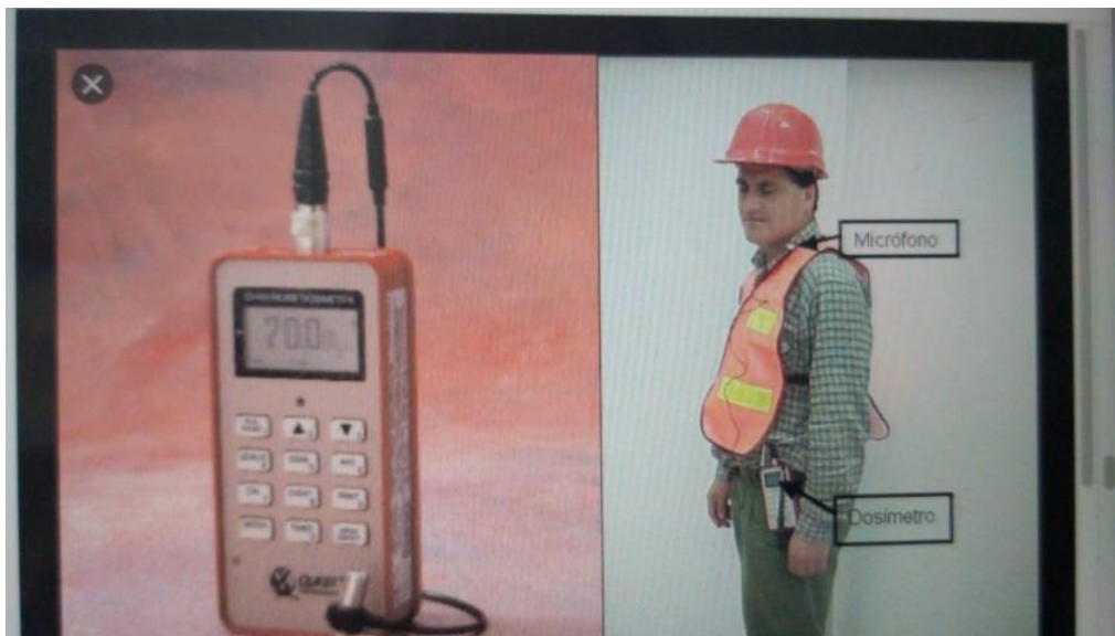
Figura 4. Instalación correcta del dosímetro de ruido en el trabajador del taller de soldadura (16)
