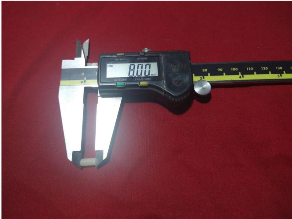
**Longitud de los cilindros de resina (8 milímetros)**
