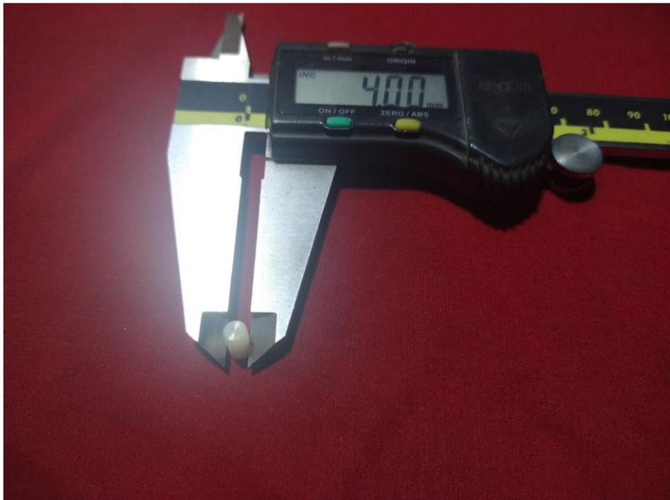
**Diámetro de los cilindros de resina (4 milímetros)**
