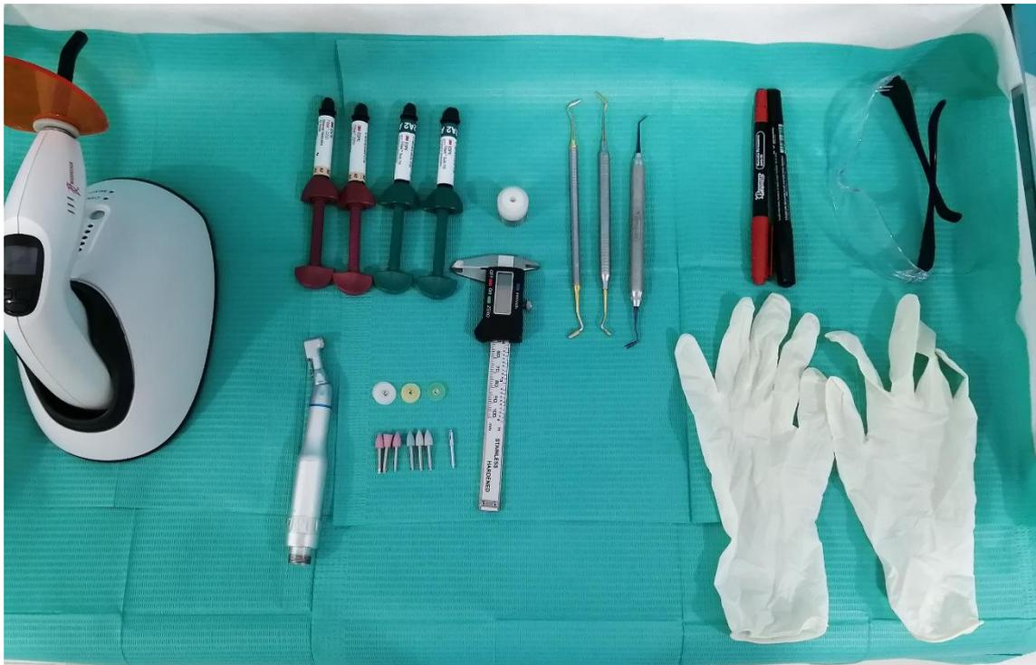
**Materiales e instrumentos empleados para la elaboración de los cilindros de resina**
