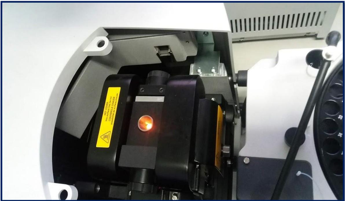
**FOTO N° 5:** Parte del espectrofotómetro de absorción atómica con horno de grafito.
