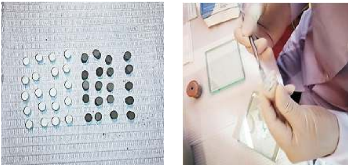
Fotografía 4: Aplicación de los cementos en la matriz y muestras cemento Portland blanco (cemento Huascarán) y Portland gris (cemento Andino).
