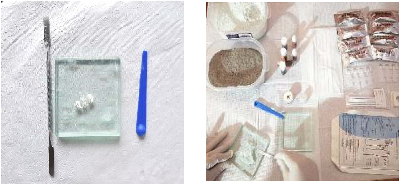
Fotografía 3: Elaboración de las muestras del cemento Portland gris (cemento Andino), cemento Portland blanco (cemento Andino) y MTA.
