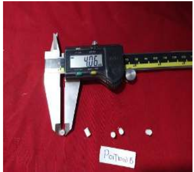
Fotografía 9: Se calibró los cilindros a base de silicato de calcio.
