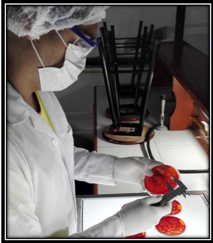
Se realiza la medición de los halos de inhibición usando un calibrador Vernier a las 24 y 48 horas
