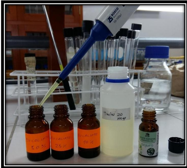
Obtención del aceite esencial de eucalipto en concentraciones al 10% 25% 50% y 100%. Se observa de manera representativa al Twin 20 como material diluyente del aceite esencial de eucalipto
