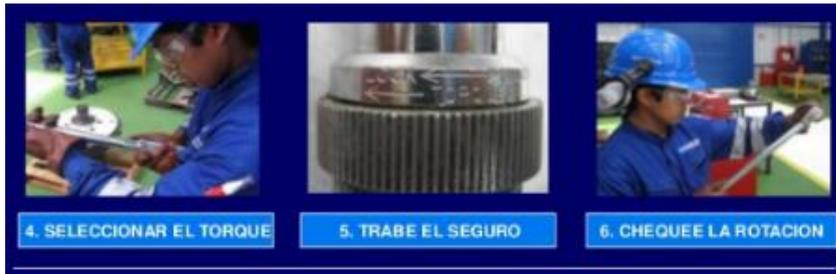
El torque de los pernos se realizará según la tabla de los valores de torque Libras-Pie.
