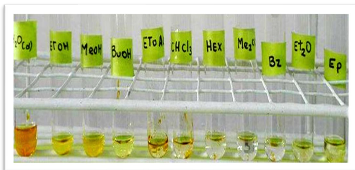
Figura 1. Prueba de solubilidad del extracto hidroalcohólico de las hojas de Munnozia hastifolia (Poepp.) H. Rob. & Brettell “Ala de murciélago”
