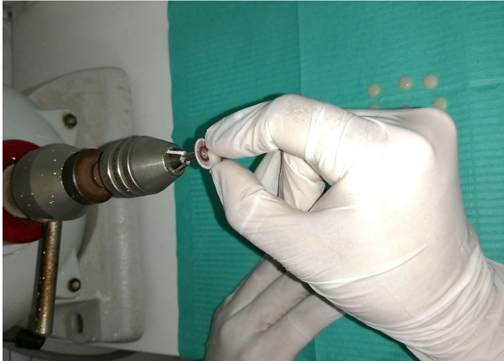
Pulido de los discos de resina con pelo de cabra
