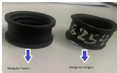
Fig1: Manguito nuevo vs deformado.
