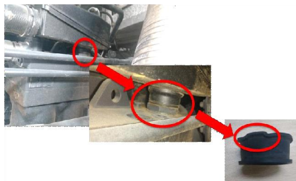
Fig 3: Ubicación del manguito resonador de compresora.
