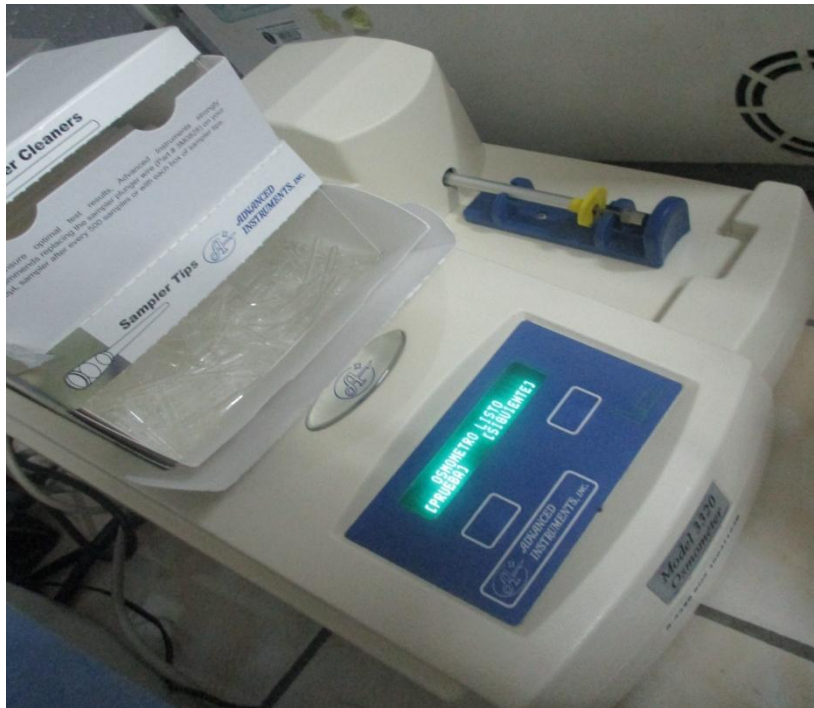
IMAGEN 02: Osmómetro, equipo que nos ayudó a la medición de la osmolalidad urinaria.
