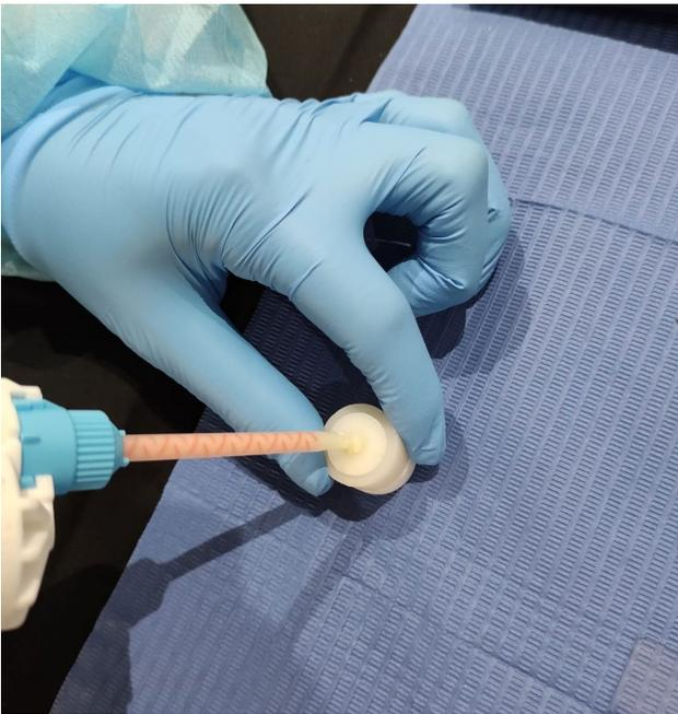
Descripción: Inyección de las resinas bis-acríticas en las matrices cilíndricas
