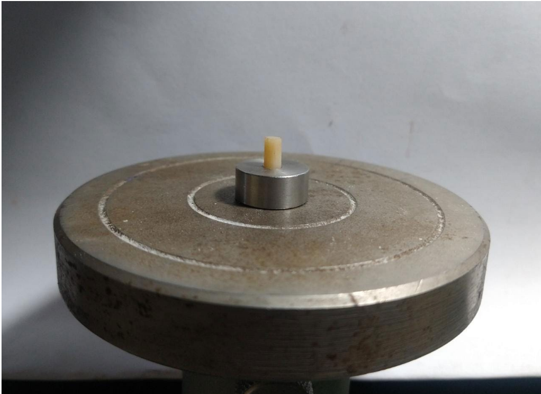
Posicionamiento de los cilindros de resina sobre la máquina de ensayos
