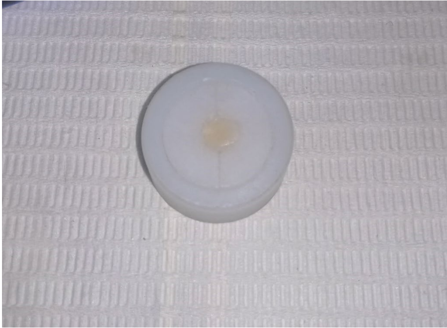
Cilindros de resina conformados en el molde plástico
