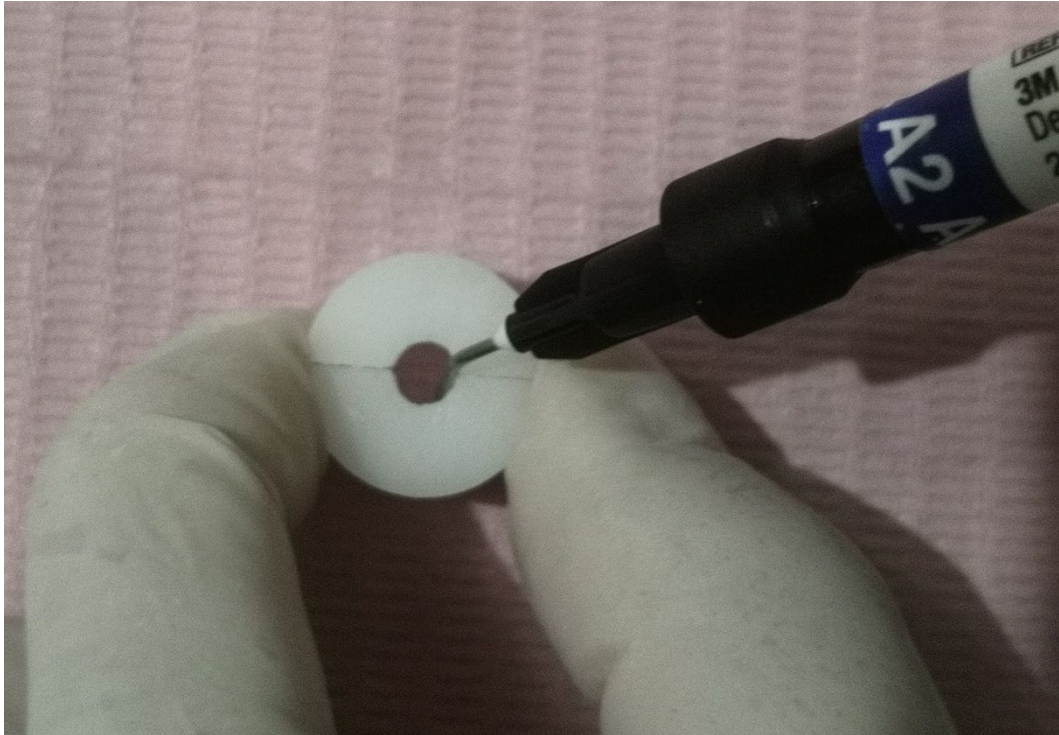
Conformación de los cilindros de resinas de baja densidad por incremento de 2 mm
