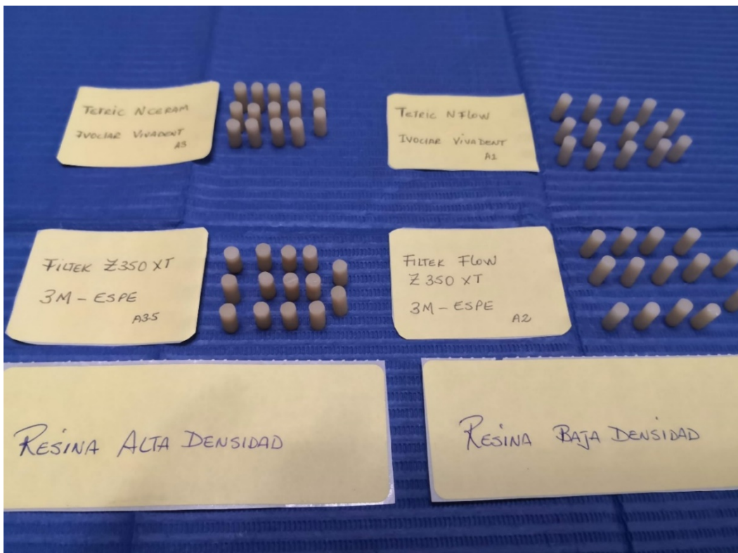
Cilindros de resinas listas y rotuladas
