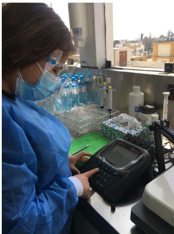
Fotografía N°6: Registro del valor de fluoruro de las muestras que tomaron, en la lectura Multiparamétrico VERSA STAR VSTAR-40A2, Thermo-Orion).
