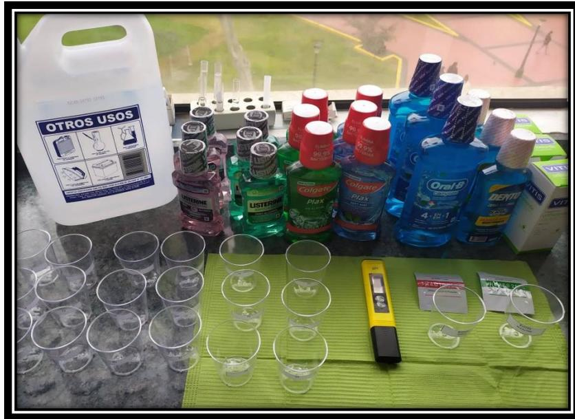
**Fotografía 2:** Preparación de las soluciones Buffer para la calibración del pH-metro (sales diluidas en 5ml de agua destilada)
