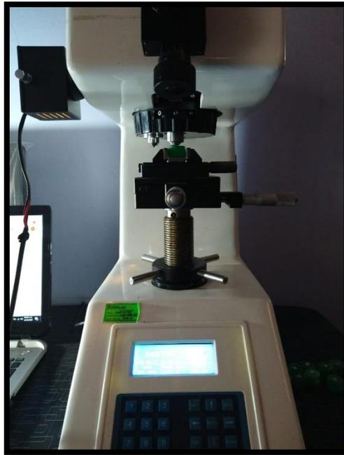
**Microdurómetro de Buhler**
