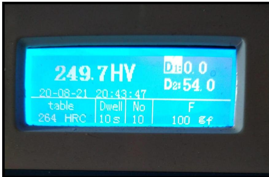
**Pantalla Digital del Microdurómetro de Buhler**
