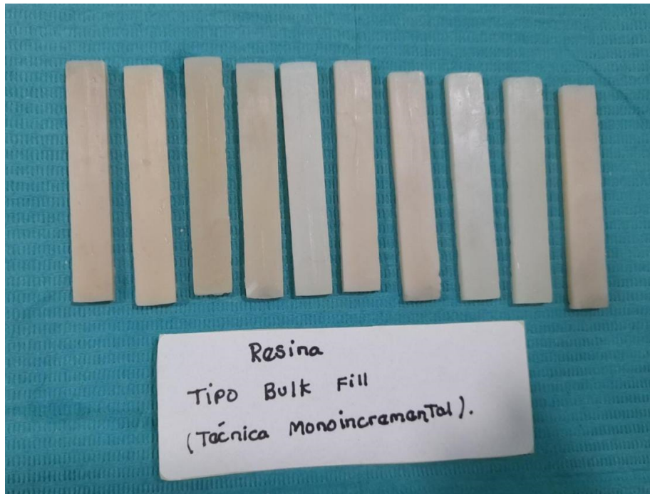
Resina bulk fill – incrementos de 2 mm
