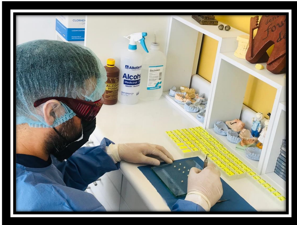
Figura 2. En esta imagen se observa la elaboración de los especímenes o discos, en arandelas de espesor 3/16, en ellos se realizaron 60 discos de resina fotopolimerizables, con dimensiones de 4mm de profundidad y un diámetro de 8mm.
