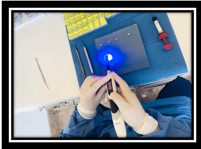
Figura 11. En esta imagen se observa el uso de la lámpara LED, para la Fotoactivación de 20 segundos, en el segundo grupo de evaluación de los 20 especímenes o discos, que están enumeradas desde el número veintiuno de espécimen hasta el número cuarenta de espécimen de unidades muestrales.
