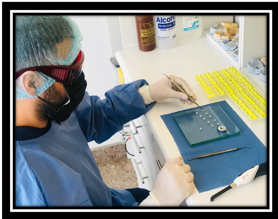
Figura1. En esta imagen se observa 3 grupos de 20 especímenes o discos, de cada grupo de evaluación (15, 20 y 30 segundos), en los periodos de 24,48 y 72 horas, un total de 60 unidades muestrales.
