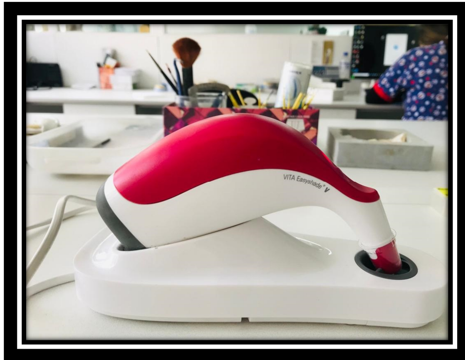
Figura 14. En esta imagen se observa la medición de la variación cromática mediante el uso del espectrofotómetro VITA.
