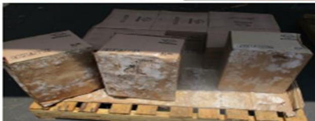
cajas deformadas por presentar humedad, paletas con moho
