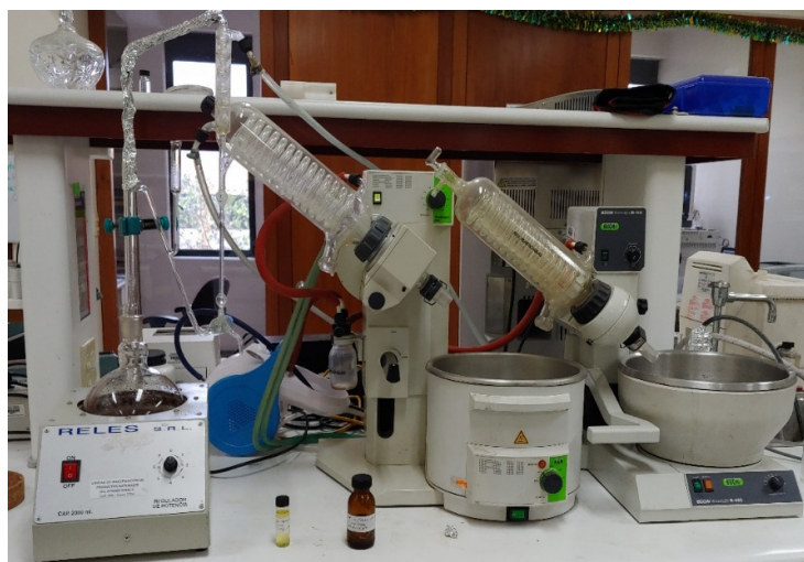
Imagen 3. Equipo Clevenger para destilación por arrastre de vapor
