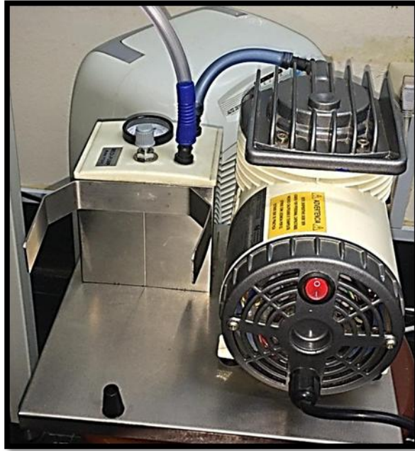
Figura 6. Equipo portátil para sistema vacío – Marca MEDI PUMP Modelo FT1811.
