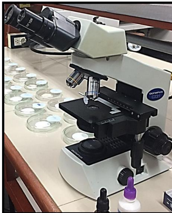
Figura 9. Microscópio óptico adaptado con ocular micrométrico – OlympusCX21.
