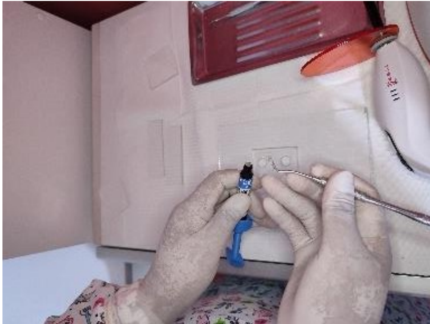
Incrementos de resina en el molde plastificado
