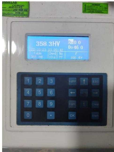
Fotografía 5. Determinación de la microdureza.
