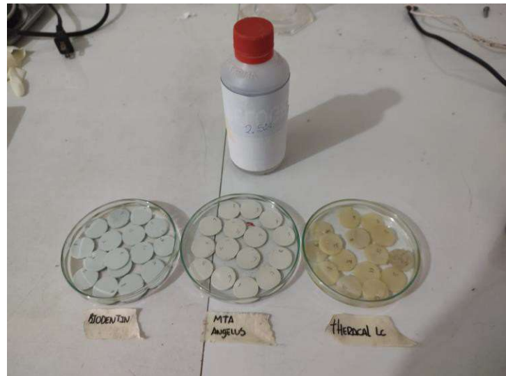
F9. Materiales que se utilizaron para sumergir y lavar los discos de theracal lc ®, biodentine ® y MTA
