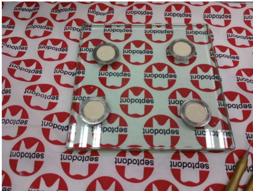
F3. Fabricación de los discos del biodentine ®
