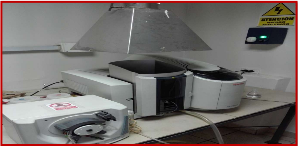
Generador de Hidruros
