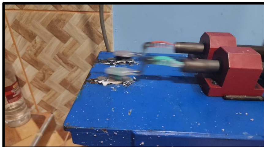
Proceso de abrasión con el variador de velocidad – Cepillado mecánico
