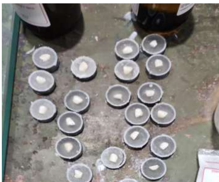
Figura 1. Para la confección de los especímenes, se obtuvieron secciones dentales con dimensiones estandarizadas de 4 x 4 mm, sometidas a un proceso de inclusión en resina acrílica, utilizando anillos de PVC como matriz de contención.
