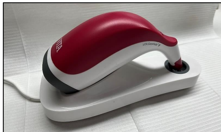
Fotografía 10: Espectrofotómetro VITA Easyshade® - Zahnfabrik (Alemania)
