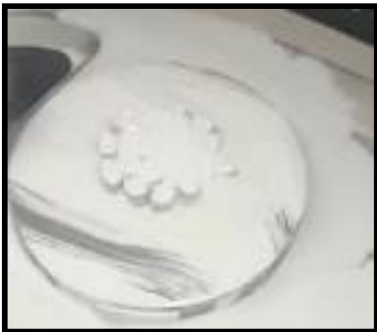
11: RETIRO DEL POLVO DE LA PLATAFORMA DE IMPRESION
