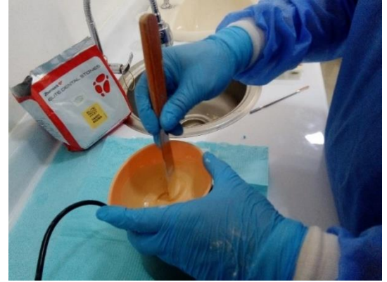
Foto 18. Mezclado manual del yeso por 60 segundos.
