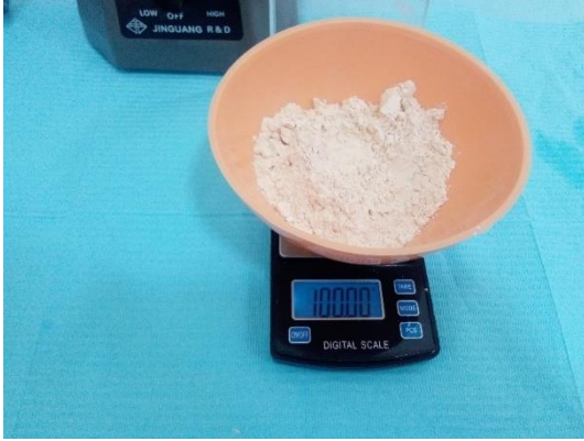
Foto 17. Pesado del yeso ELIT ROCK TIPO IV, 100g de yeso por 20ml de agua
