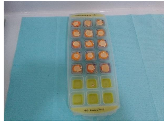
Foto 20. Fraguado del yeso ELITE ROCK FAST en 25 minutos .
