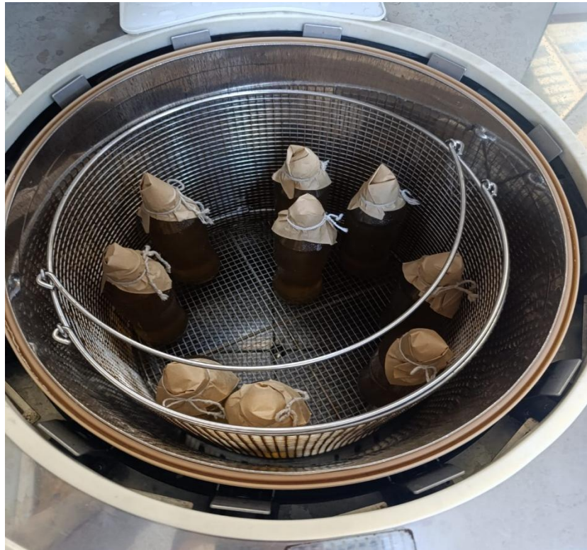
Autoclavado de los medios a utilizar.
