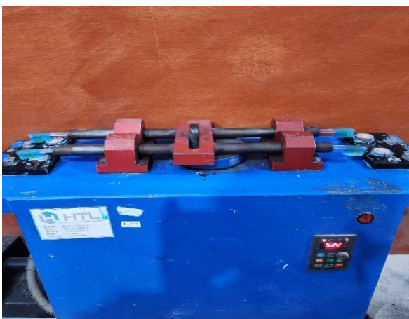
Muestras sometidas a cepillado con variador de fuerzas
