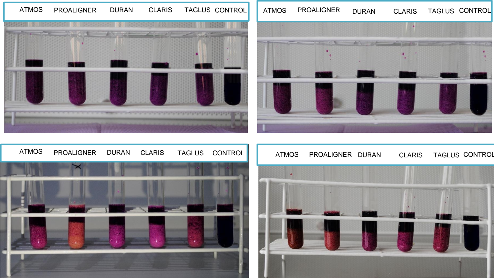
Figura 10. Cambio de color por lixiviación de cinco marcas de polímeros termoplásticos expuestos en permanganato de potasio concentrado a las 0 horas, 15 minutos, 8 horas y 24 horas.
