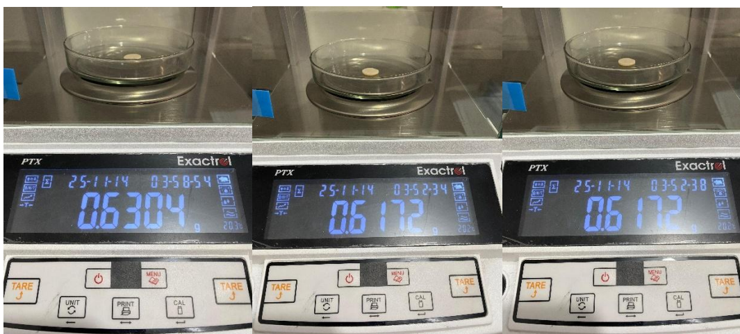
Proceso de foturado y medición de sorción y solubilidad
