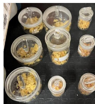
Pesa filtros con muestra húmeda llevar a estufa
