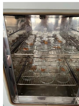
Muestras secas después de 1 hora a 105°C en la estufa
