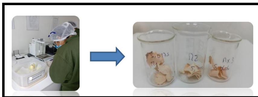
Figura 12. Determinación del porcentaje de humedad de la raíz de jergón sachá.
