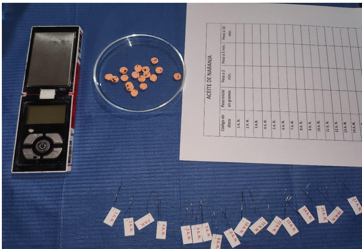
PESADO Y ROTULACION Y REGISTRO DE PESO INICIAL
