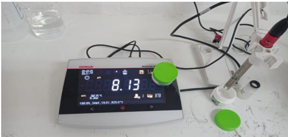
Foto 16 Determinación de la conductividad
