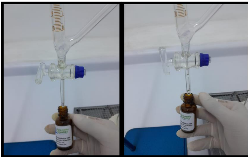
Obtención de aceite esencial de las semillas de Citrus aurantifolia swingle del tubo graduado del aparato Clevenger
