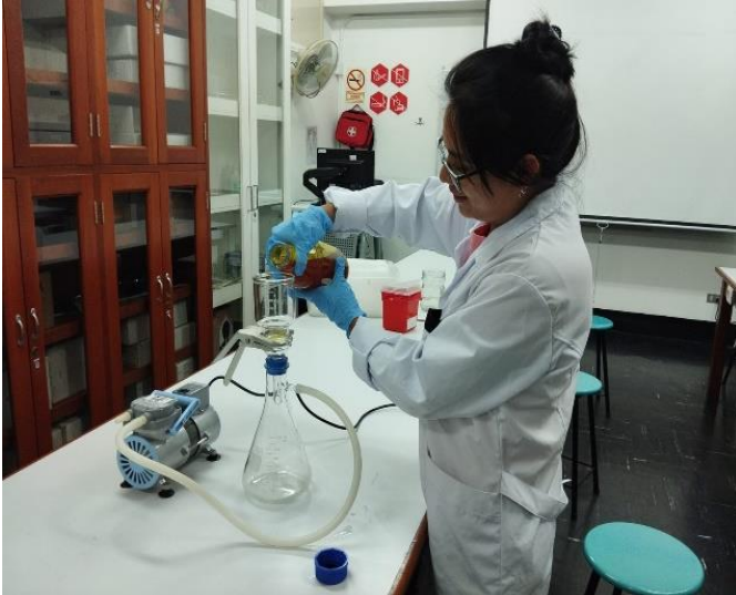
Figura 4: Filtración en bomba al vacío, del extracto etanólico de Curcuma longa
